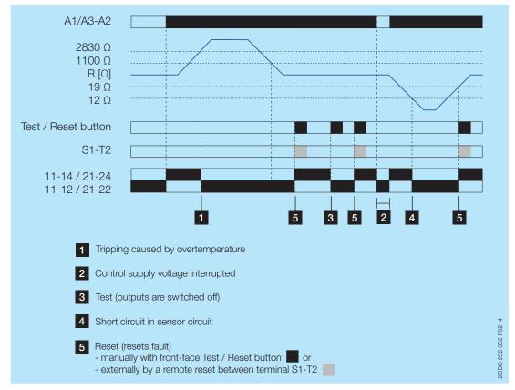
CM-MSS.32, CM-MSS.33 Manual reset
